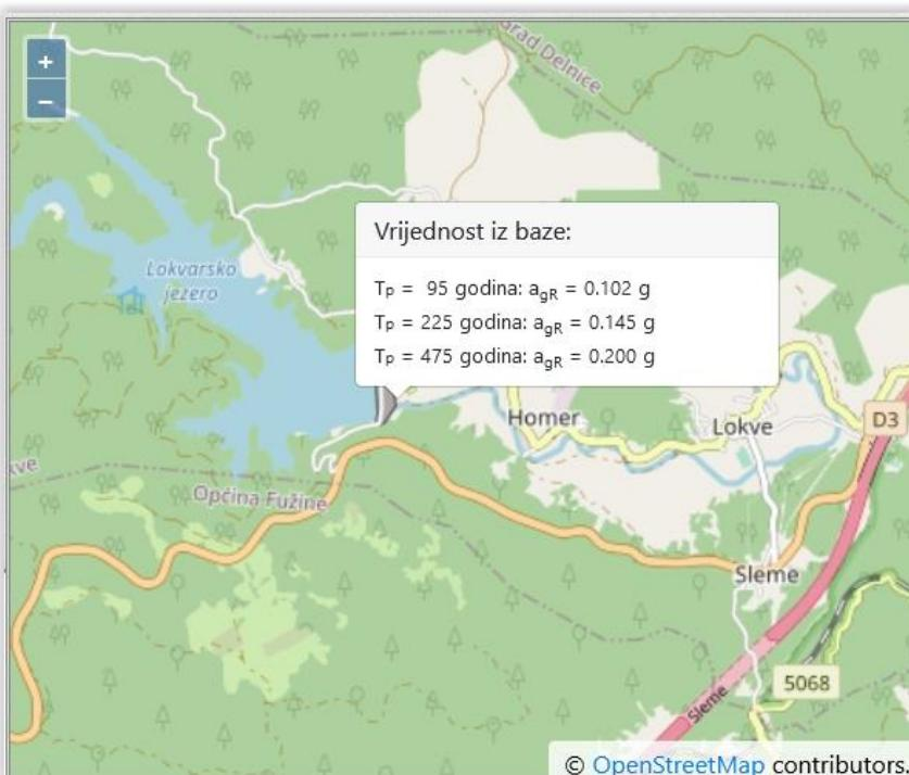
**Slika 20.** Vrijednosti horizontalnih vršnih ubrzanja za područje zahvata u jedinicama gravitacijskog ubrzanja ( $1g=9,81 \text{ m/s}^2$ ). Prikaz vrijednosti za tri povratna razdoblja. Izvor: <http://seizkarta.gfz.hr/hazmap/karta.php>
