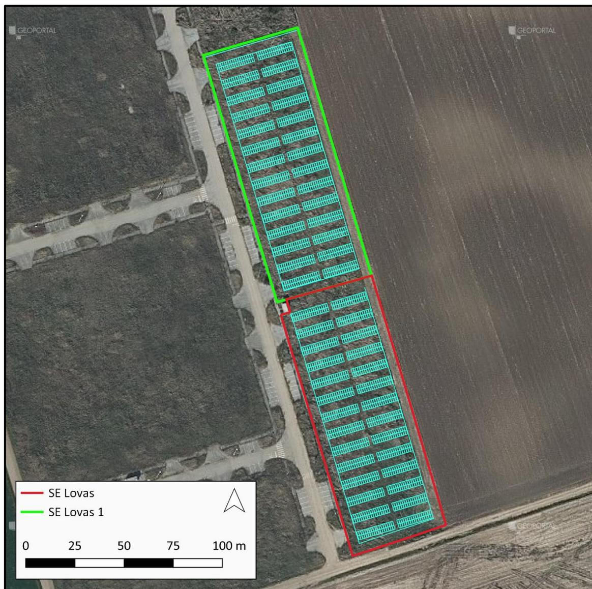
Slika 2.1-3. Raspored fotonaponskih panela u SE Lovas i SE Lovas 1 (podloga: Geoportal, 2022.)
