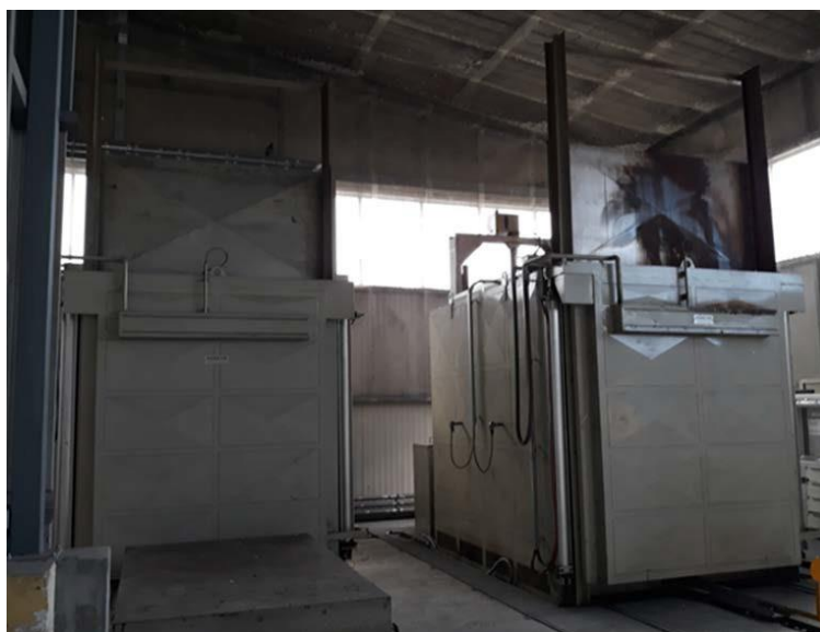
Slika 10. Elektropeći za toplinsku obradu odljevaka
