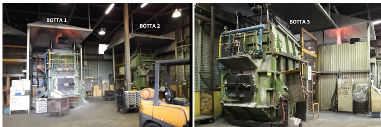
Slika 3. Plinske talioničke peći za taljenje ingota
