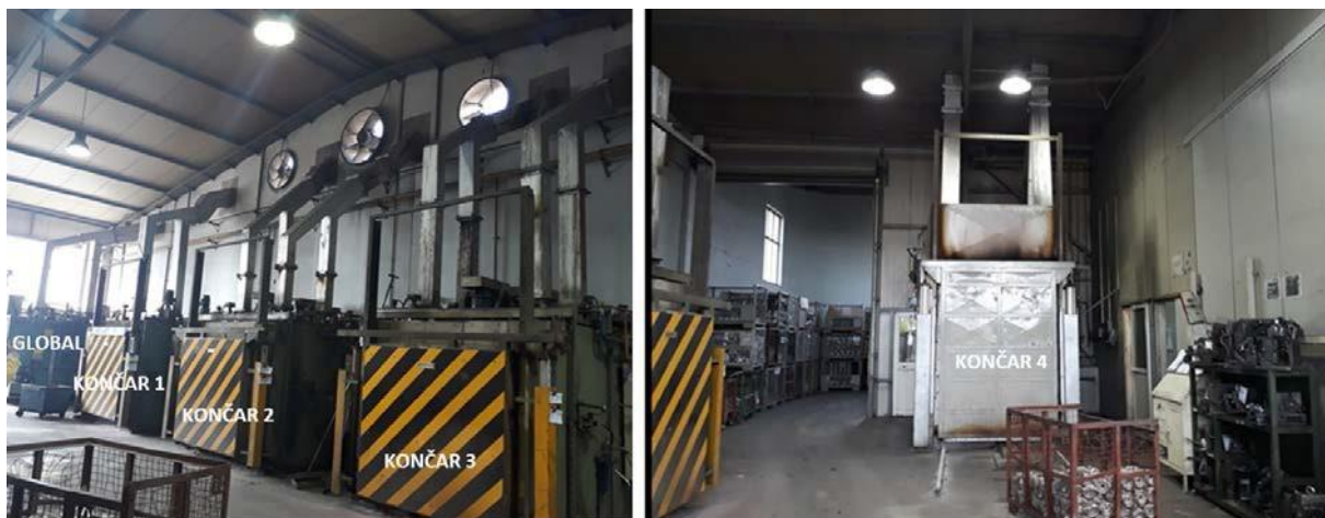
Slika 8. Peći za žarenje odljevaka za istresanje jezgri
