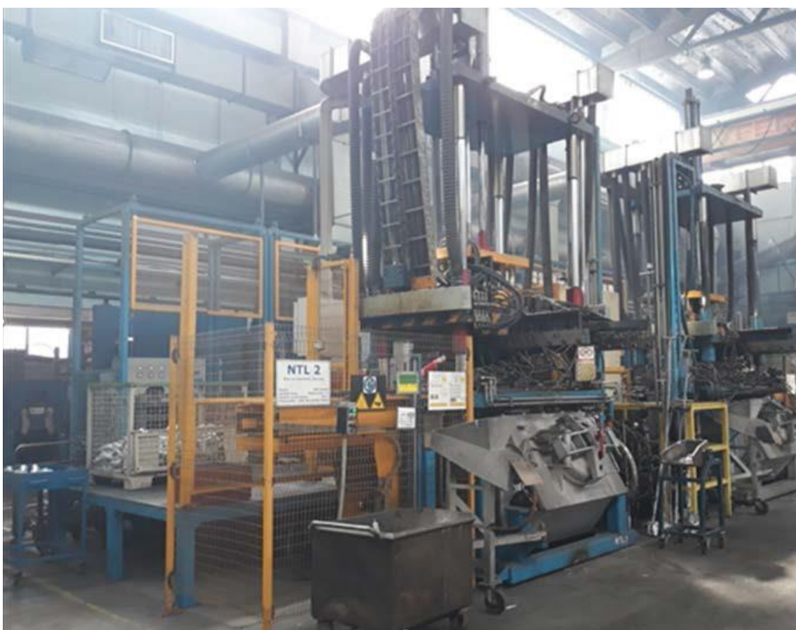
Slika 5. Linija za niskotlačno lijevanje
