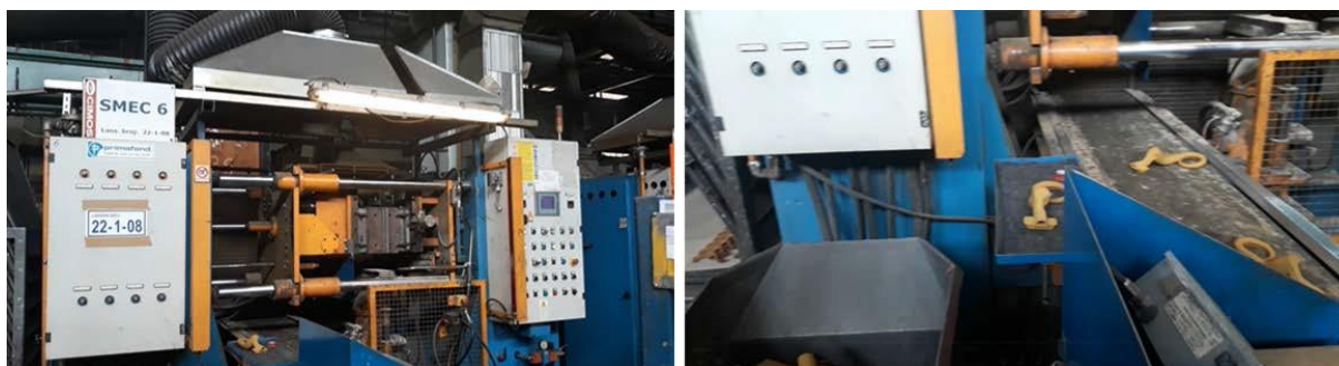
Slika 6. Stroj za izradu jezgri i gotove jezgre na izlazu iz stroja
