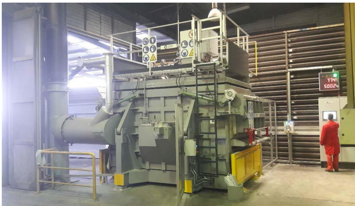
Slika 4. Plinska peć za taljenje strugotine
