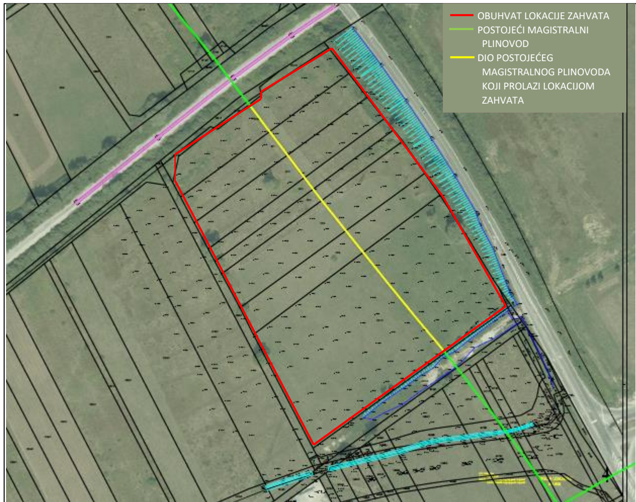
Slika 1. Prikaz trase postojećeg plinovoda na lokaciji zahvata.
